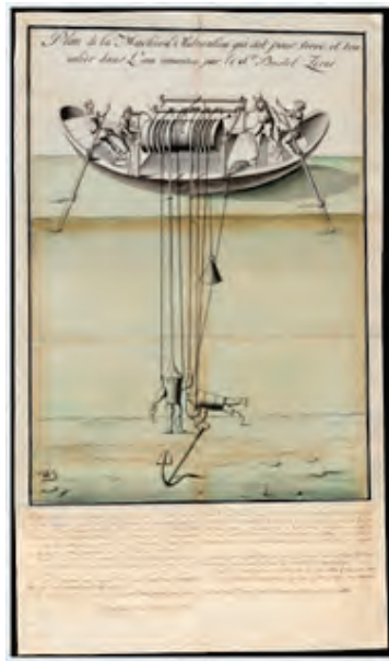
Plano de máquina hidráulica para vivir y trabajar bajo el agua inventada por Burllet Zeres. 1796. Archivo del Museo Naval.
